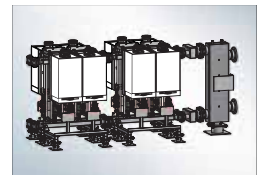
Système en cascade à huit chaudières dans une configuration adossée
